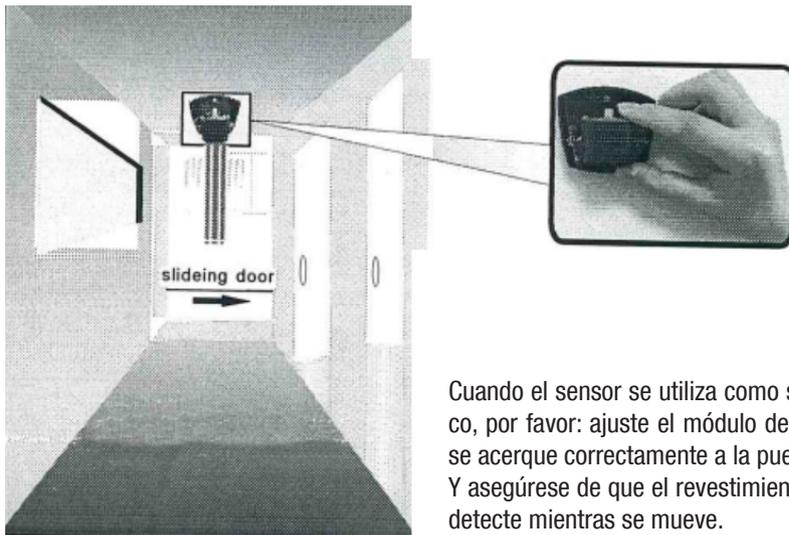
Quando el sensor se utiliza como sensor anti-pellicco, por favor: ajuste el módulo del sensor para que se acerque correctamente a la puerta.
