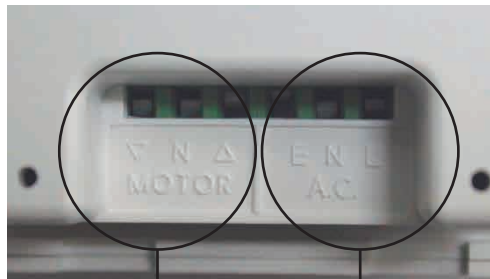
Conexión del motor
