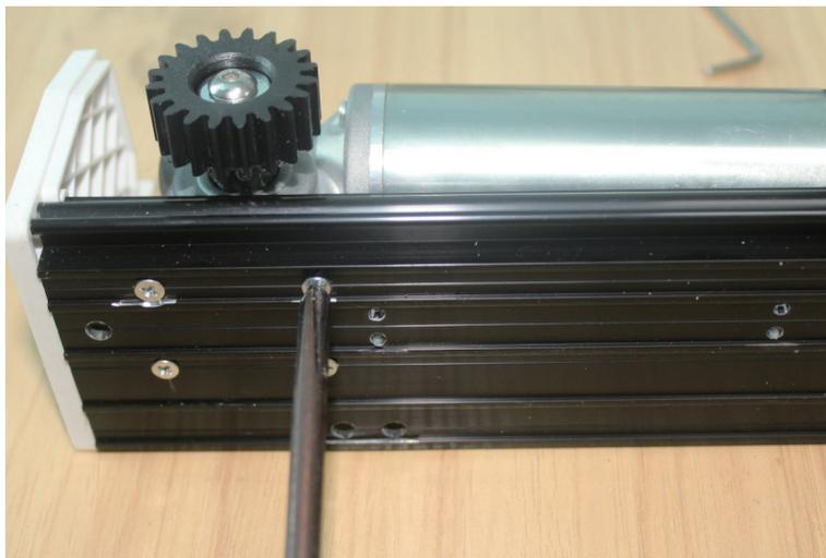
6. Afloje los 4 tornillos de fijación del controlador (no es necesario quitarlo)
